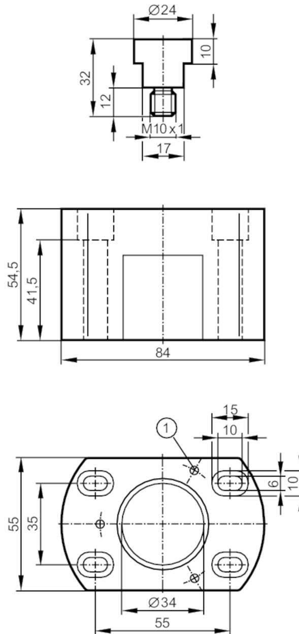
1 鑽孔 將閥門感測器固定在適配器上
