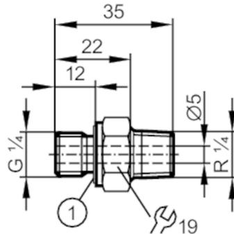
1 Vedação da conexão do processo
