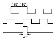
Sentido de giro en el sentido de las agujas del reloj (mirando hacia el eje)
