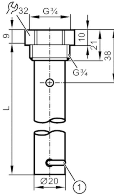
1 Abrazadera de fijación para la pieza de centrado
