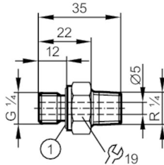
1 Junta de estanqueidad de la conexión del proceso
