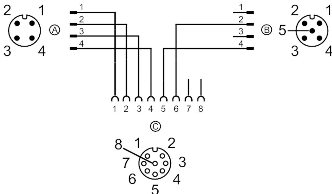
Conector: 1 x M12; cuerpo: PUR; bloqueo: latón, niquelado
