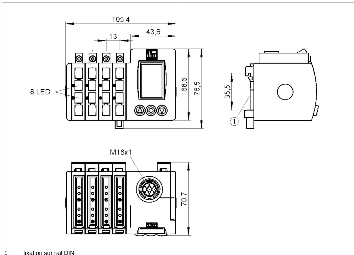
1 fixation sur rail DIN
