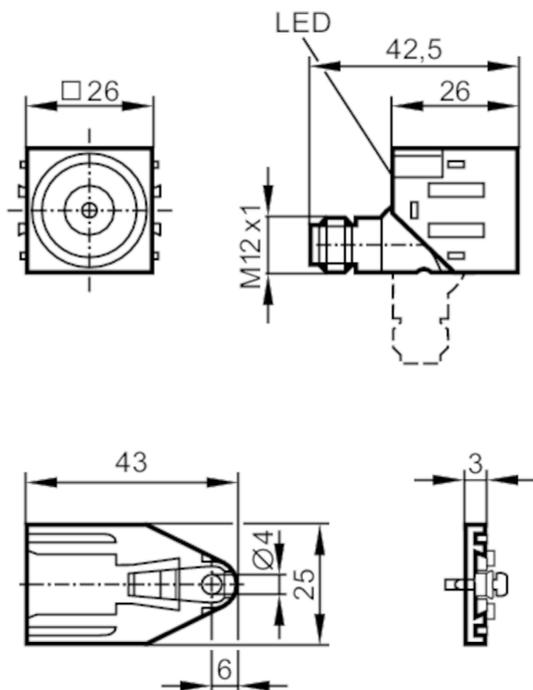
1 スナップ式取付け構造
