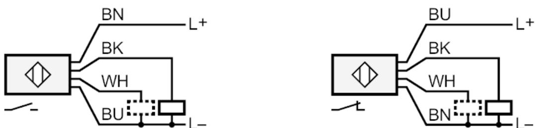
WH: Uscita di controllo funzione cavo di programmazione
