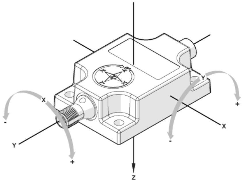
posizione di montaggio orizzontale / rotazione intorno agli assi x e y
