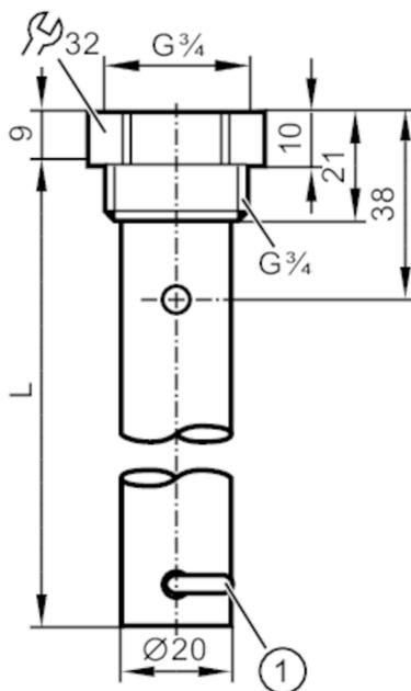
1 clip di fissaggio per elemento di centraggio
