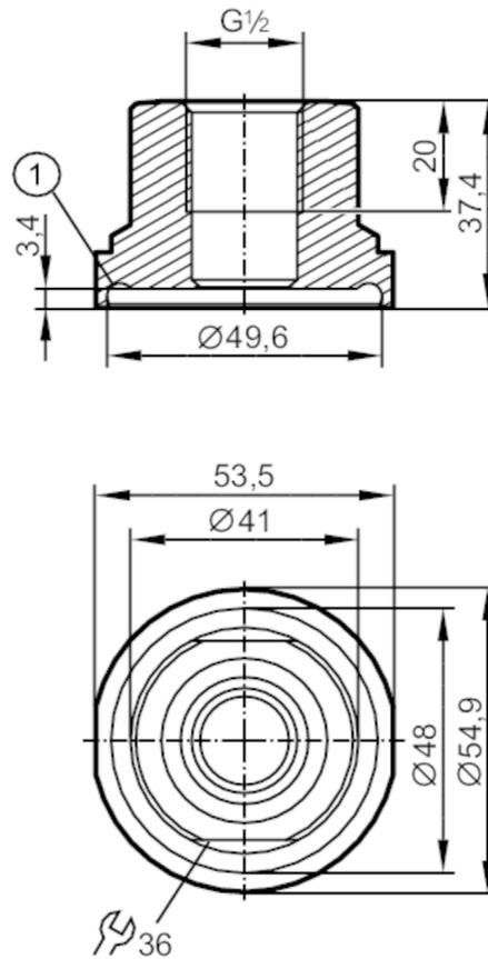
1 Scanalatura per O-ring DIN 11864-R-40x5
