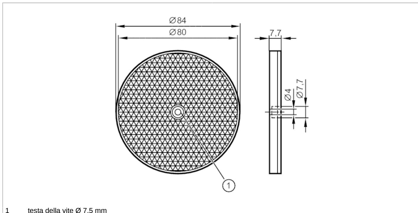
1 testa della vite  $\varnothing$  7,5 mm
