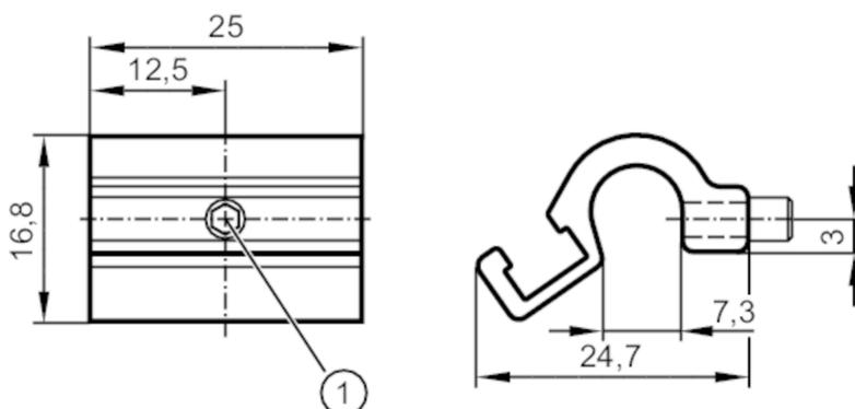
1 Vite di fissaggio SW 2
