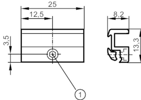
1 Vite di fissaggio SW 1,5
