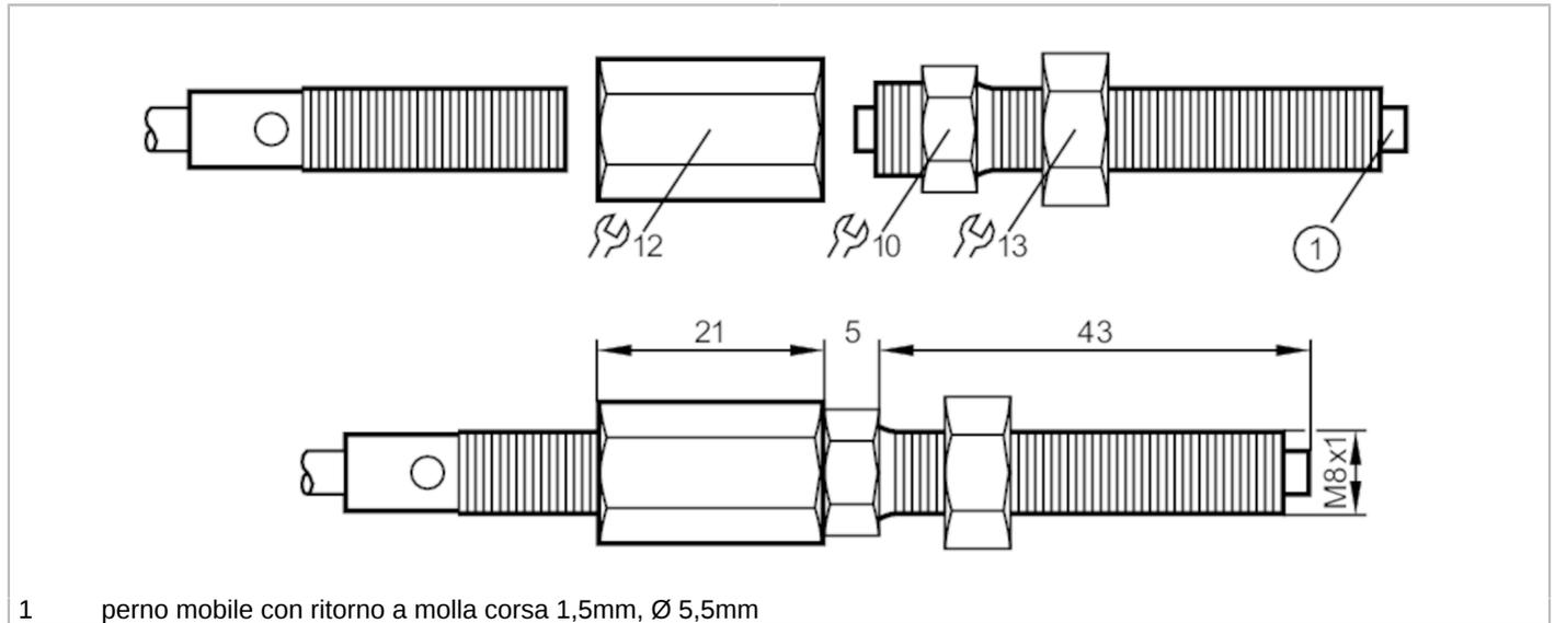
1 perno mobile con ritorno a molla corsa 1,5mm, Ø 5,5mm
