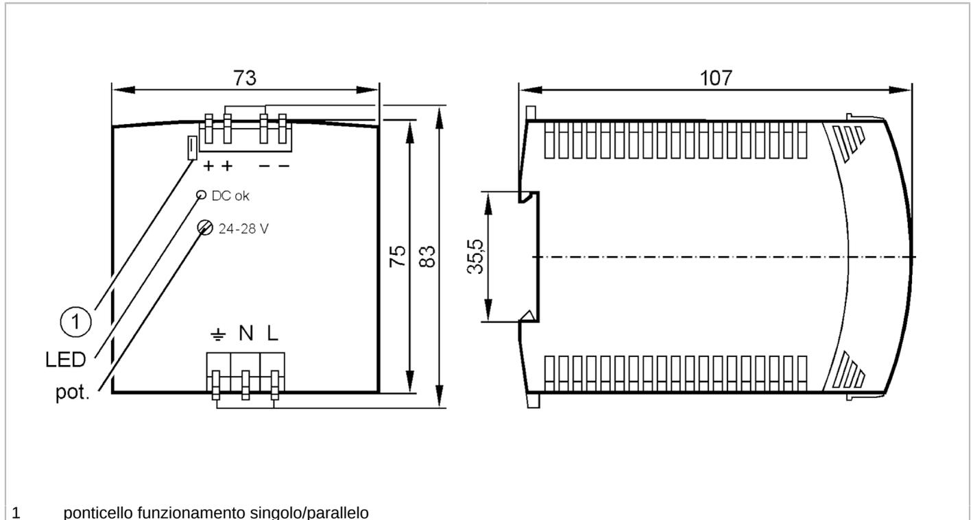
1 ponticello funzionamento singolo/parallelo
