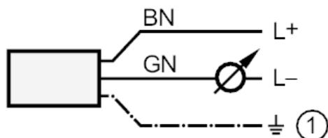
1: pelindung (terhubung ke casing)
