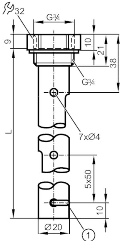
1 braket pemasangan untuk komponen pemasat
