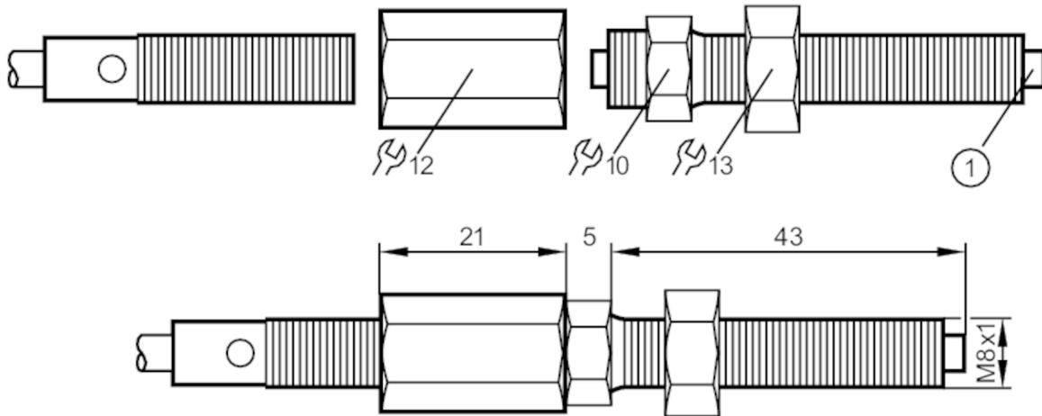
1 baut yang dapat bergerak dengan pegas balik langkah 1.5mm, Ø 5.5mm
