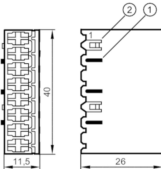
圖形顯示具封閉蓋的接點外殼
