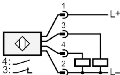
Conector: 1 x conector para válvulas tipo A DIN (DIN EN 175301-803)
