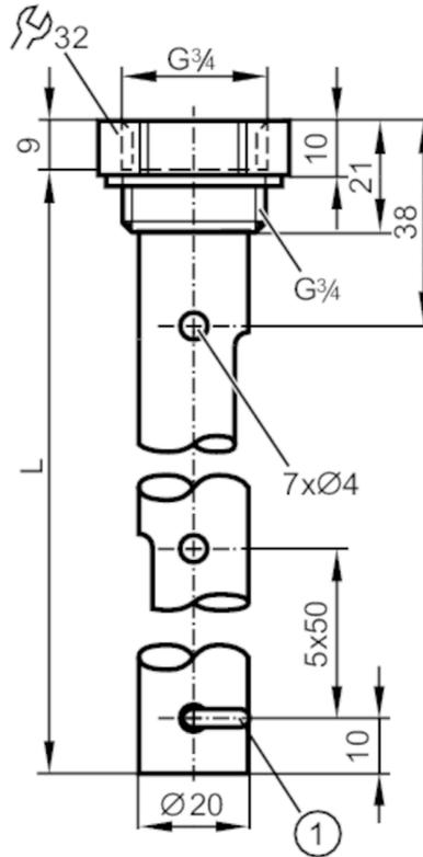
1 abrazadera de fijación para la pieza de centrado
