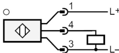
Steckverbindung: 1 x M8; Codierung: A
