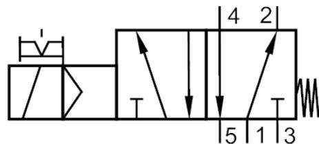
1 x válvula de corredera de 5/2 vías (sin solapamiento) monoestable
