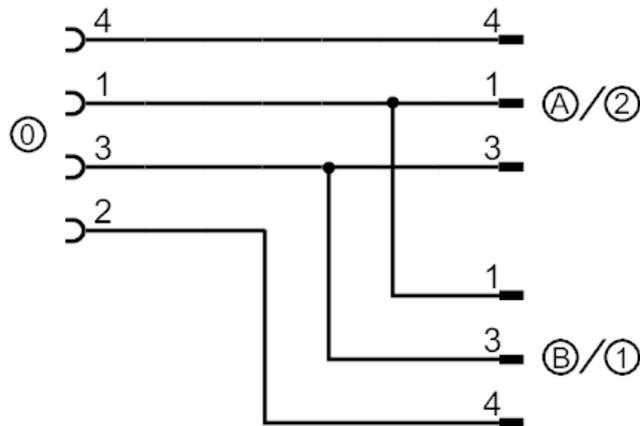
Connettore: 1 x M12, diritto; codifica: A; Corpo: TPU, nero; Fermo: zinco pressofuso, nichelato; Guarnizione: FKM; Contatti: dorato; Coppia di serraggio: 0,6...1,5 Nm
