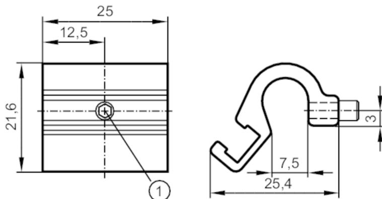
1 Vite di fissaggio SW 2
