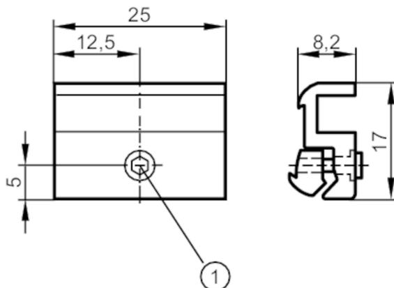
1 Vite di fissaggio SW 1,5
