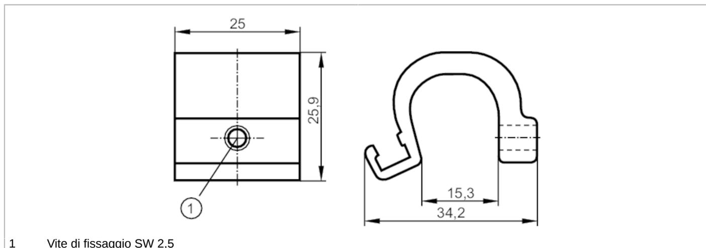
1 Vite di fissaggio SW 2,5
