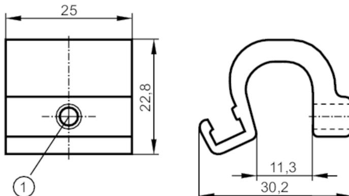
1 Vite di fissaggio SW 2,5
