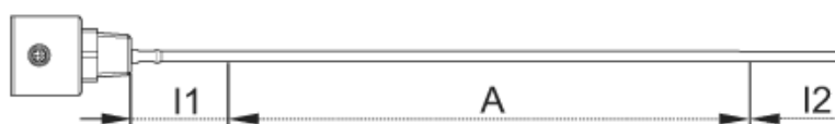
Déviations de mesure D dans les limites de la zone active de la tige de sonde
