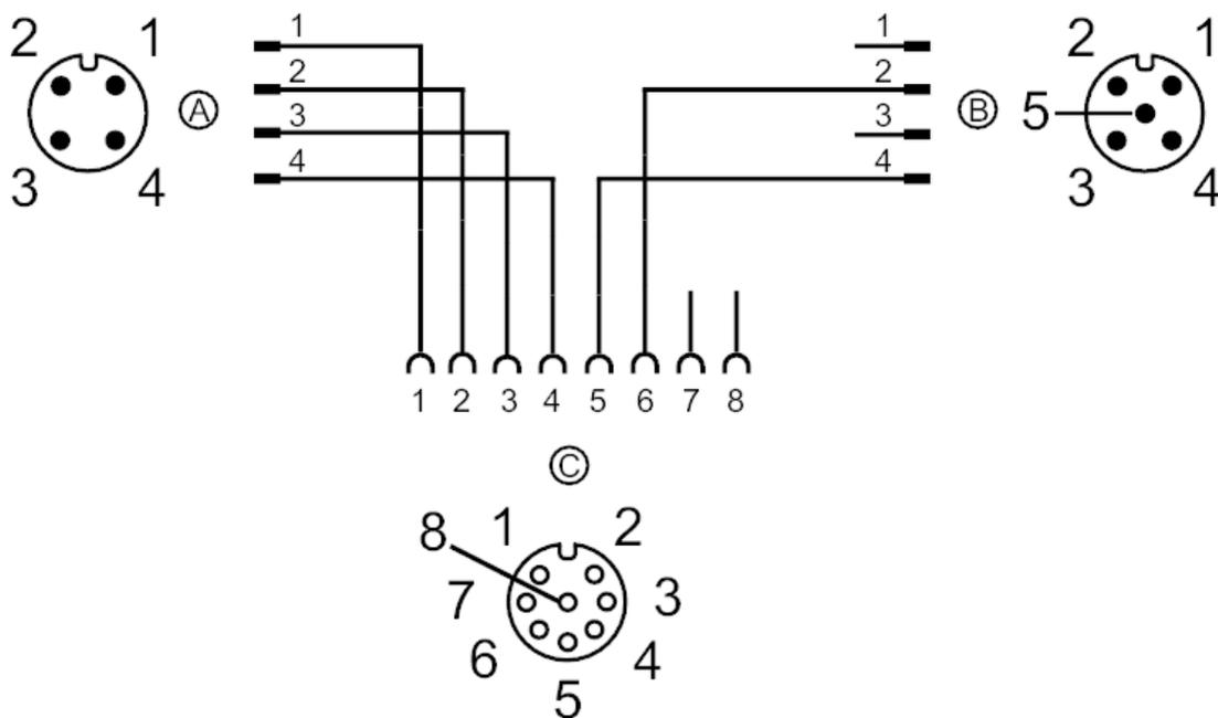
Connecteur: 1 x M12; Corps: PUR; Verrouillage: laiton, nickelé
