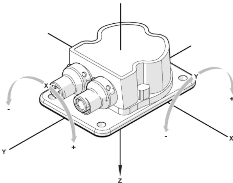
horizontale Einbaulage / Rotation um X- und Y-Achse
