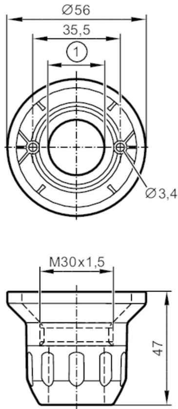
1 Dichtung im Lieferumfang für Rohre mit 22 mm oder 25 mm Durchmesser
