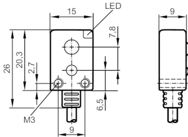
le photorécepteur se trouve derrière la lentille supérieure
