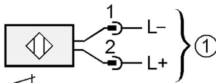
1 =                   raccordement à l'amplificateur
