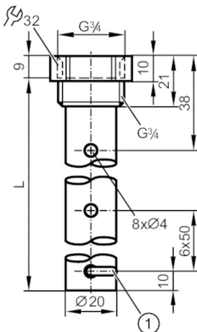
1 Suporte de fixação para peça centralizadora
