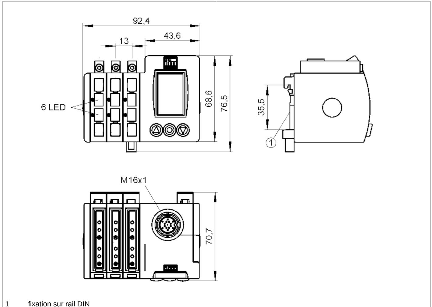
1 fixation sur rail DIN
