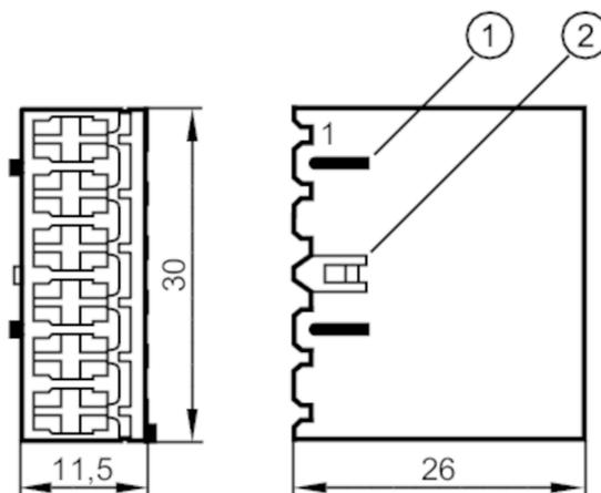
illustration montre le boîtier de contact avec capot fermé
