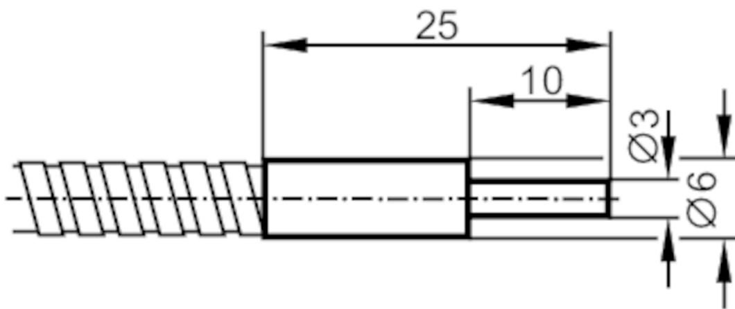
**Application**Principe de fonctionnement Barrage photoélectrique**Zone de détection**Portée avec amplificateur pour fibres optiques de type OKF; OUF**OKF**Portée des fibres optiques [mm] 120**OUF**Portée des fibres optiques [mm] 120**Conditions d'utilisation**Température ambiante [°C] -40...290**Données mécaniques**Type tête de détection droitDiamètre de la tête de détection [mm] 3Longueur de la tête de détection [mm] 10
