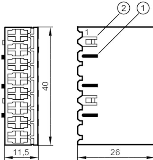
Abbildung zeigt Kontakt-Gehäuse mit geschlossenem Deckel
