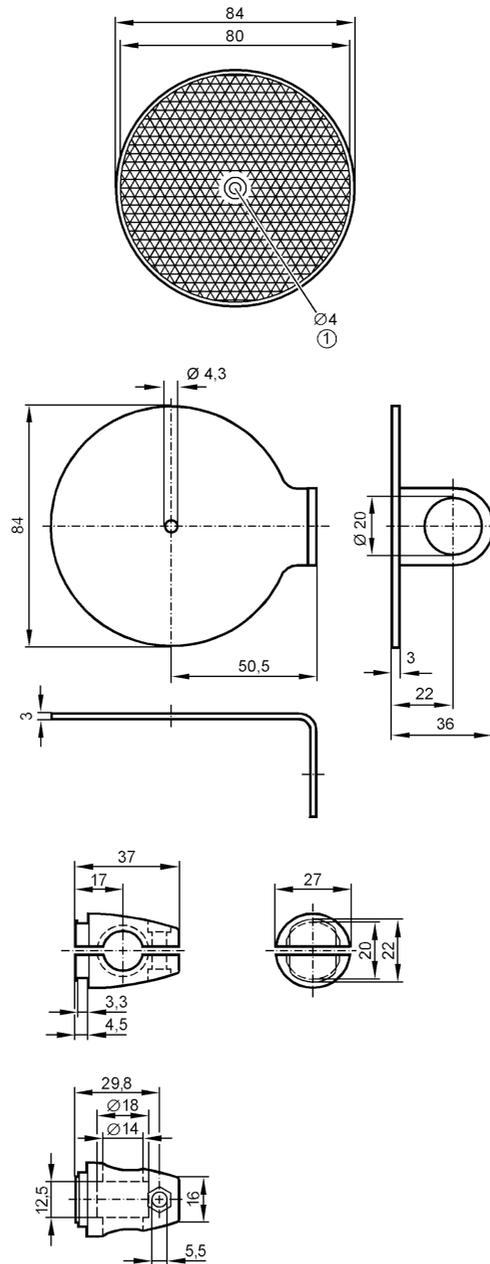
1 Schraubenkopf  $\varnothing$  7,5 mm
