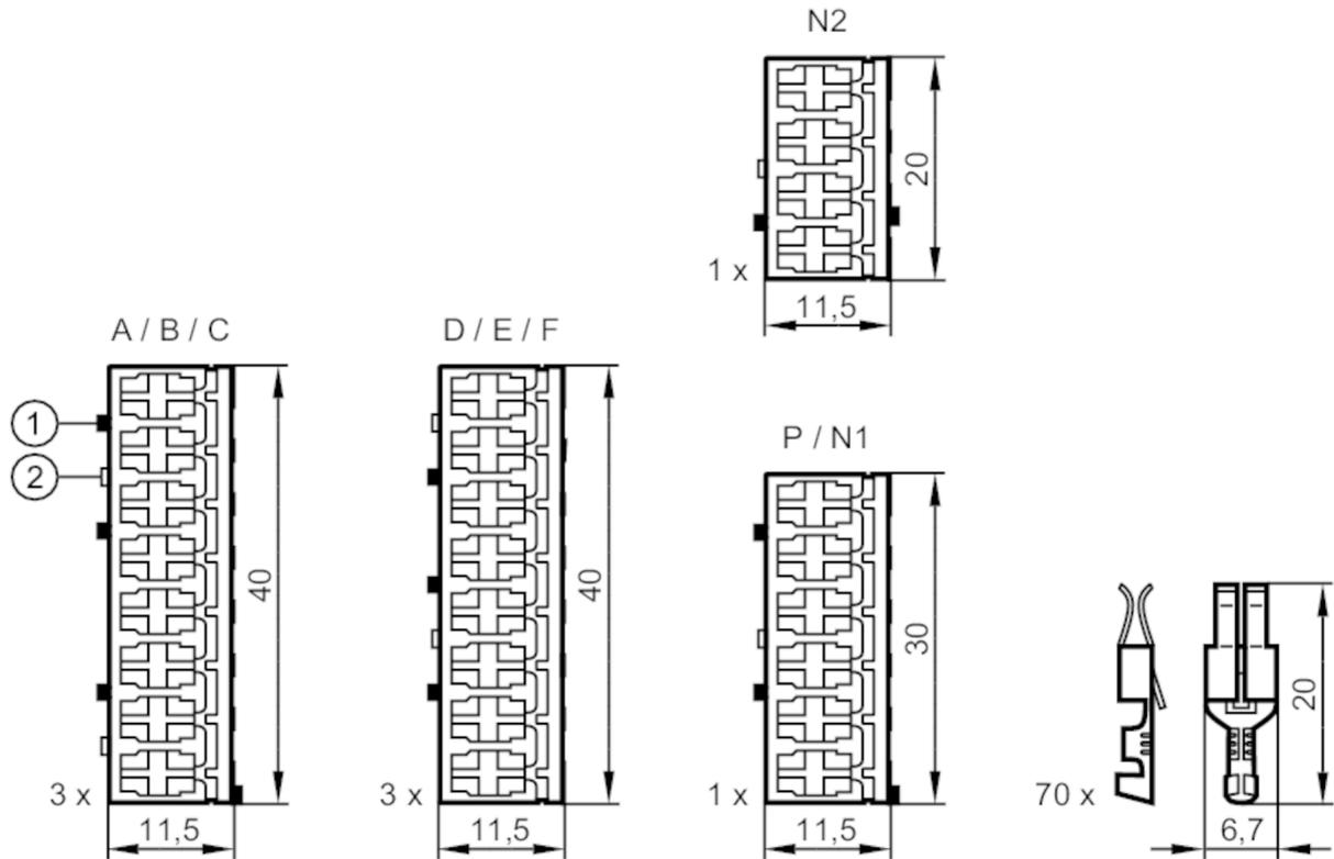
La imagen muestra la pieza para contactos con las tapas cerradas
