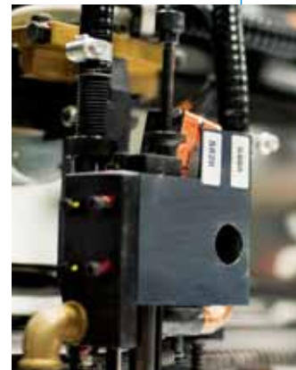
Due sensori induttivi del tipo IS5070 controllano rispettivamente (su ogni lato) la perpendicolare corretta della pila di fogli tramite una leva articolata.
