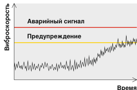
Анализ тенденции вибрации машины в соответствии с ISO 10816
