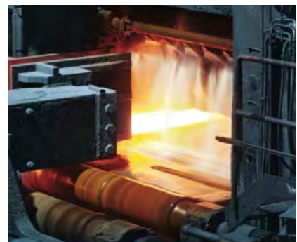
Rilevamento della posizione di bramme di acciaio in un laminatoio.
