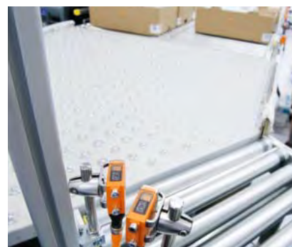
Misurazione del tempo di volo al prezzo di un sensore standard.
