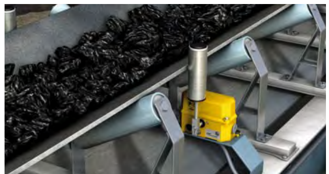
Installazione in un interruttore a fune e interruttore di allineamento nastro
