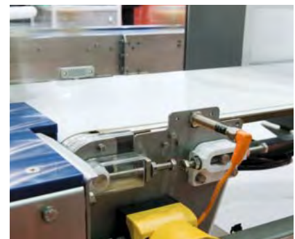
Rilevamento sicuro di merce trasportata su un nastro.
