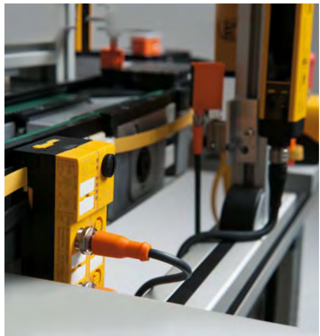
Conexión de bus de seguridad para barreras fotoeléctricas
