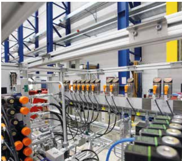
02 IO-Link-Sensoren liefern Daten zur optimalen Maschinensteuerung
