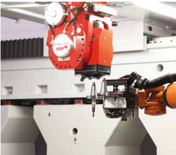
05 Bei Bedarf lassen sich die Prozesssensoren für jedes Werkzeug individuell parametrieren
