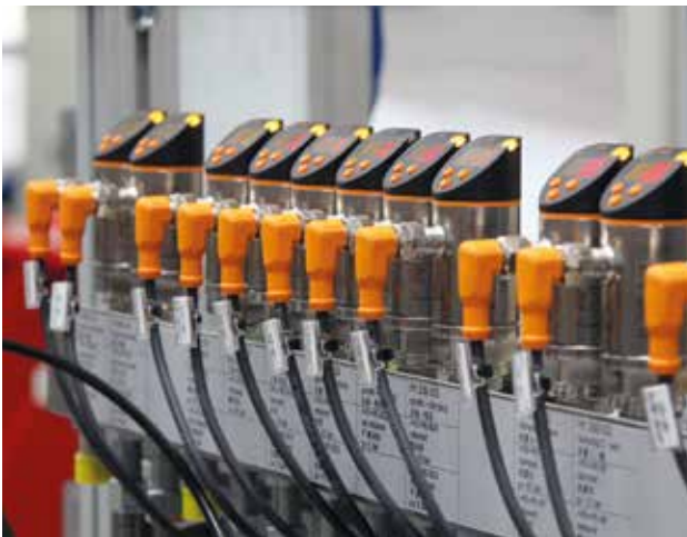
04 Die zahlreichen IO-Link-Sensoren sind zentral parametrierbar
