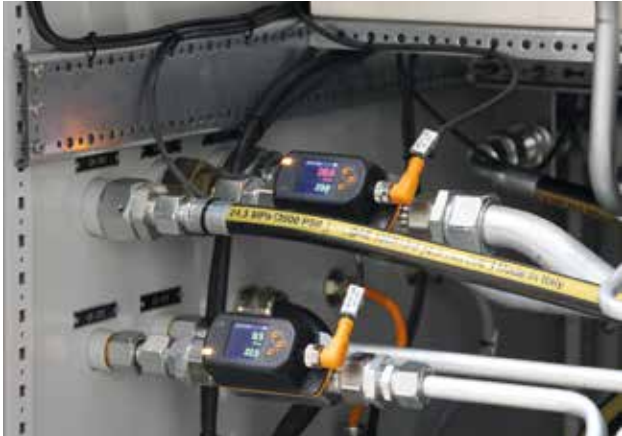
06 Spart Kosten: Zwei Messwerte (Durchflussmenge und Temperatur) mit nur einem Sensor
