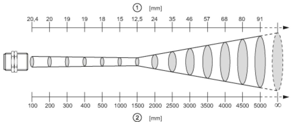
1 diamètre du spot de mesure
