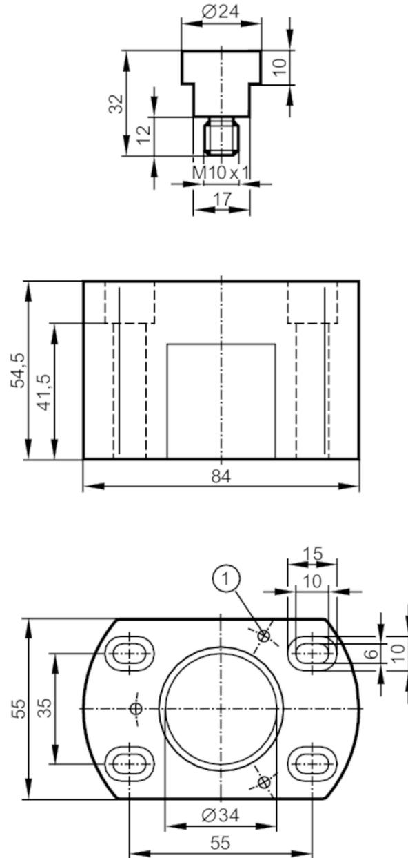
1 perçage pour fixer le détecteur pour vannes sur l'adaptateur
